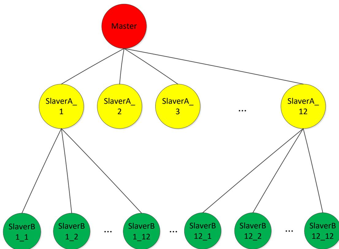
多连接组网采用一拖 12 从节点的连接方式连接，其中 12 个从节点 (slaverA)，每个节点又拖 12 个节点的方式连接。实现 157 个 FR8016H 节点连接。
